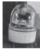
クレーンモード時にLEDの外部表示灯が点灯
