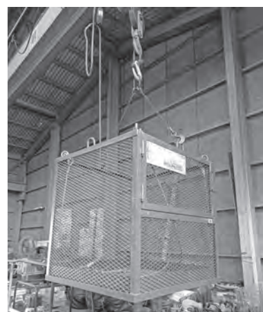
クレーン吊り下げ式ゴンドラ
